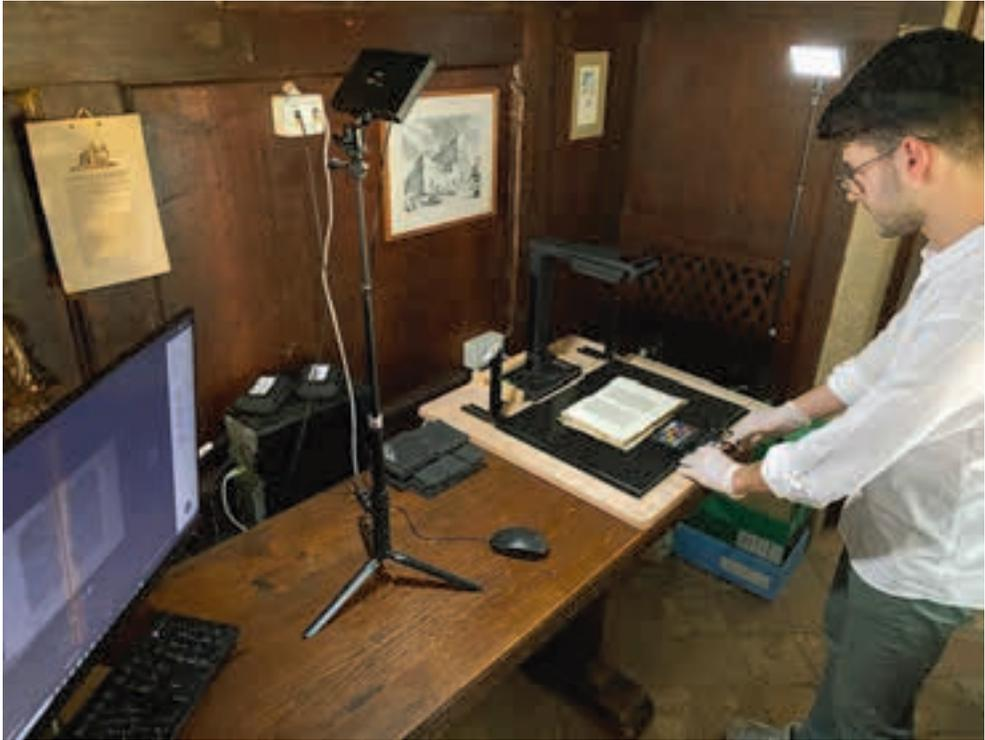
5. Lo studio fotografico allestito presso l'Ateneo Veneto per il progetto: a sinistra, il monitor, con il computer e gli hard disk di archiviazione; a destra, la postazione di digitalizzazione e, disposti lateralmente, i faretto Led
